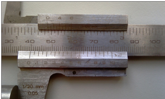
Abb. 3: Die Höhe dieses Test-Zylinders beträgt 3,97 \text{ cm} . (Foto: Martin Apolin)
