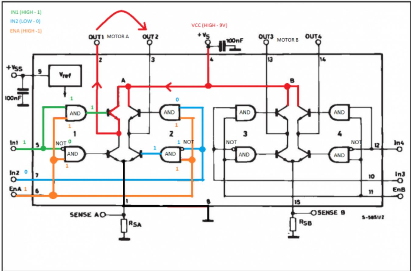
Die oben angeführte Belegung der Eingänge (In1, In2 & EnA) hat zur Folge, dass sich der Motor aufgrund der Stromrichtung von OUT1 zu OUT2 von links nach rechts dreht. Würde man die In1 und In2 jeweils umgekehrt belegen, so würde sich der Motor von rechts nach links drehen.
