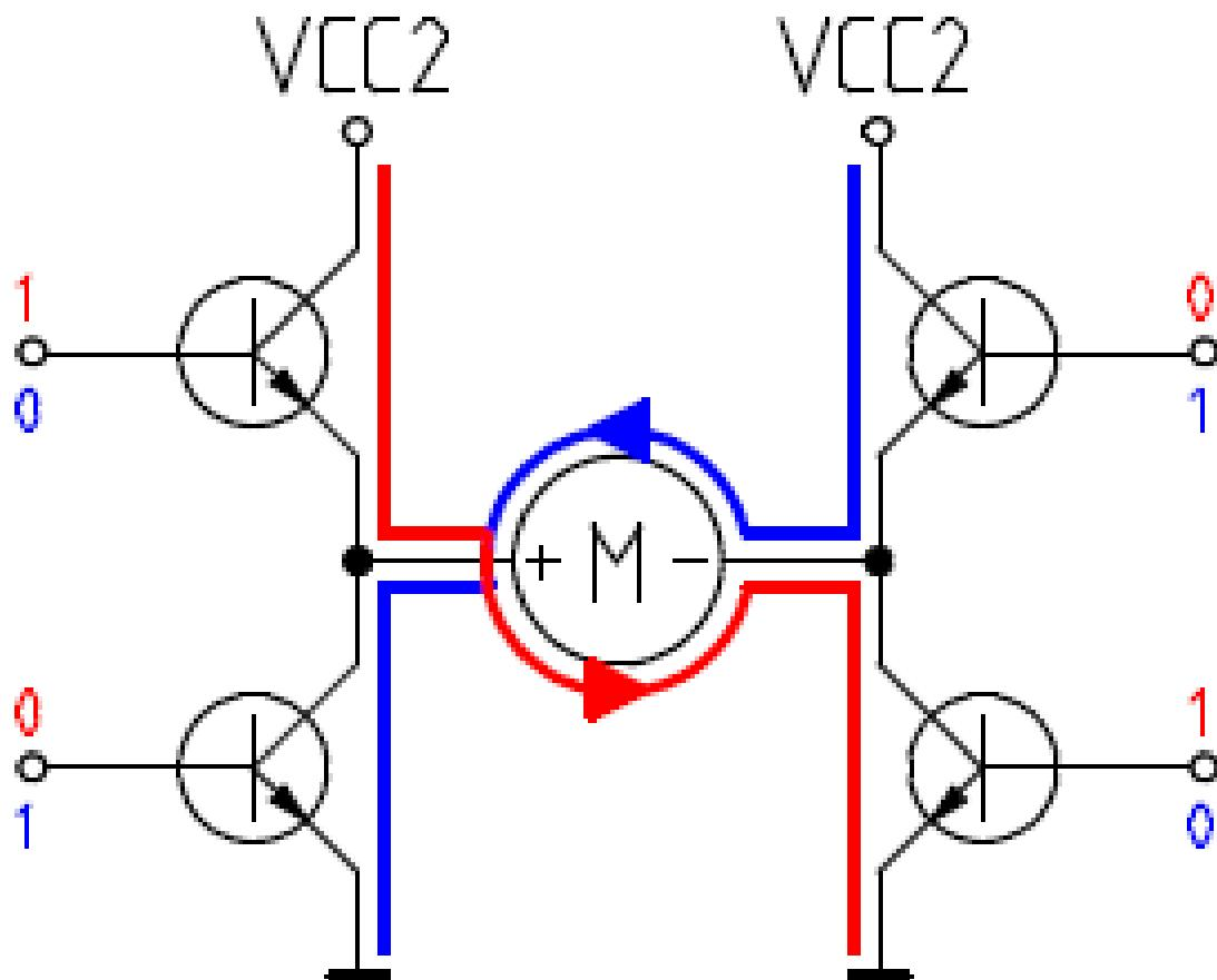
Mithilfe von einer H-Brücke **kann man die Stromrichtung beim Ausgang selbst bestimmen**. Das heißt, schließt man als Ausgang einen Motor an, so dreht sich der je nach Eingänge nach links oder nach rechts. Dazu muss man nur wissen, wie man die Eingänge entsprechend belegen muss. Dazu wiederum muss man zuerst verstehen, wie eine H-Brücke funktioniert. In den nachstehenden Bildern wird die Funktionsweise der H-Brücke erläutert.
