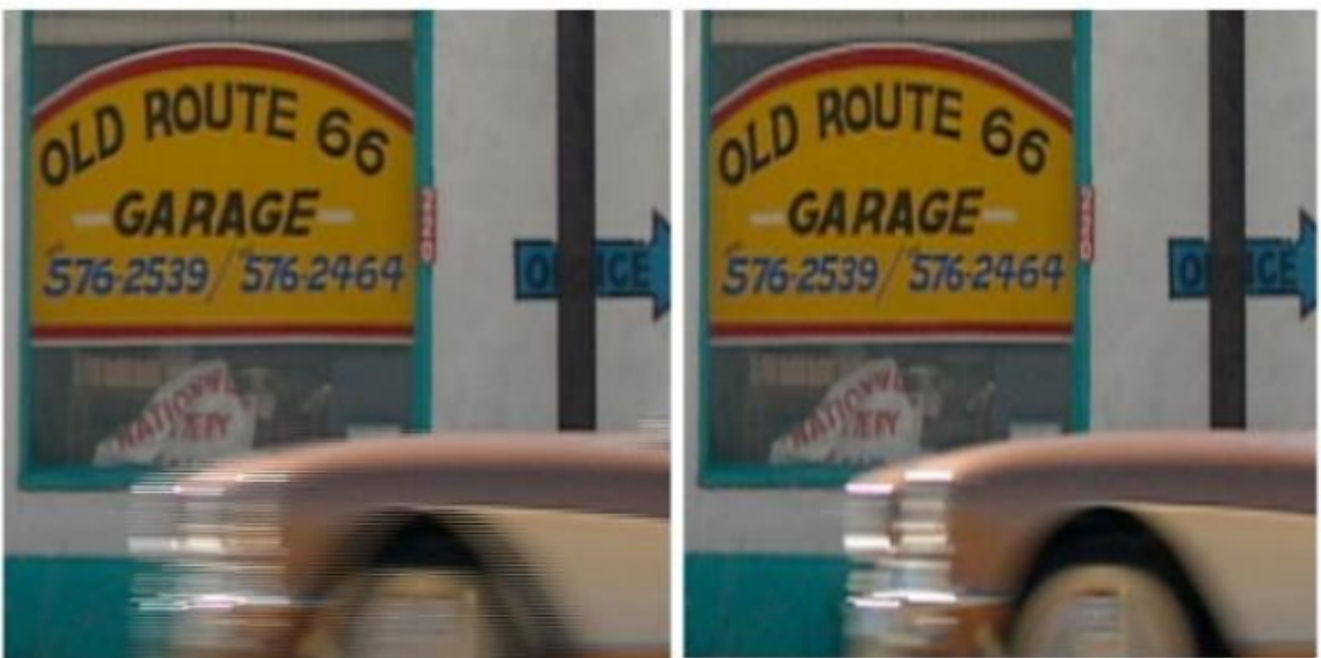
Links: Zwei Halbbilder vereint (50i), Rechts: Progressive Abtastung (25p)
