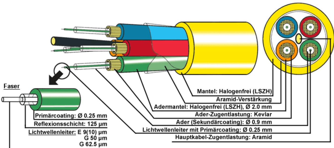
Da die Fasern sehr dünn und empfindlich sind, werden sie zum mechanischen Schutz mit einer Kunststoffbeschichtung („Coating“) und einem Schutzüberzug versehen. In einem LWL-Kabel können mehrere Fasern, sogar in mehreren Bündeln, zusammen gefasst sein.
