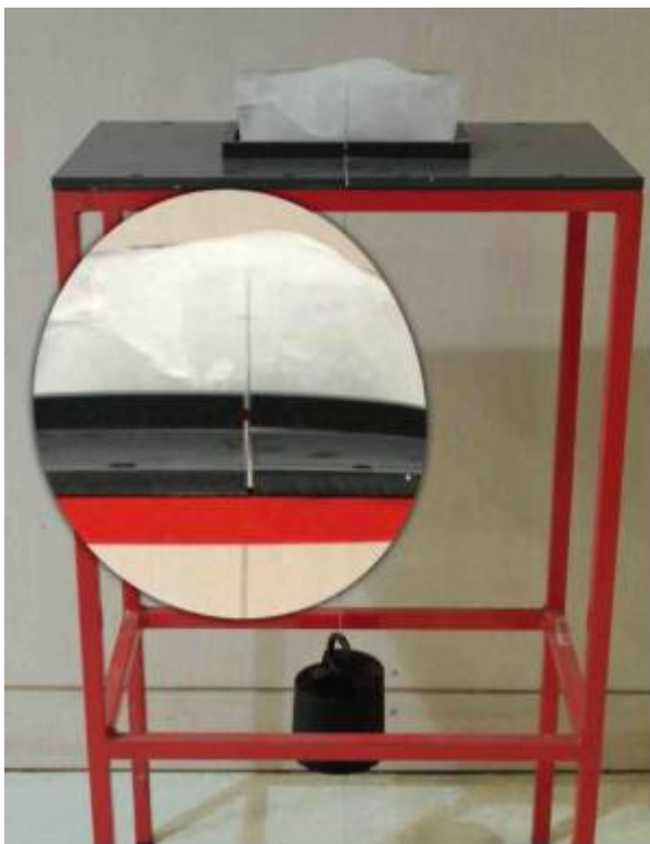
Eine Drahtschlinge wandert durch einen Eisblock.
