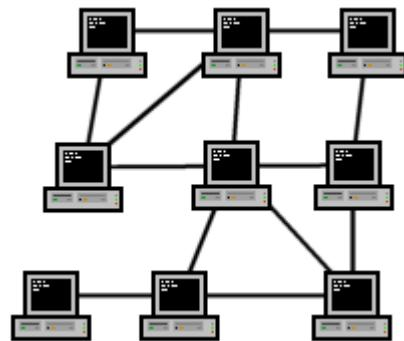
Vorherrschende Netzstruktur in großflächigen Netzen (z.B. öffentliche Telekommunikationsnetze).
