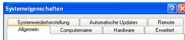
Ein PageControl soll oft das gesamte Formular ausfüllen. Das erreicht man, indem man die Eigenschaft *Align* auf *alClient* setzt. Neue Seiten fügt man während der Entwurfszeit über die Option *Neue Seite* im Kontextmenü hinzu.
