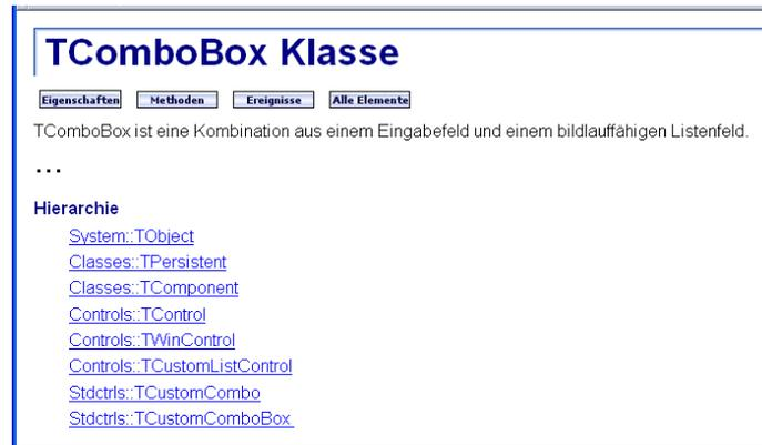
Die Klasse *TComboBox* enthält deshalb alle Elemente von *TCustomListControl*. Da eine *TListBox* ebenfalls von *TCustomListControl* erbt, kann man die gemeinsamen Elemente einer *ListBox* und einer *ComboBox* auf dieselbe Art verwenden.
