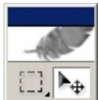
Mit dem **Verschieben-Werkzeug** wird eine Auswahl oder Ebene zu einer neuen Position im Bild verschoben. Die Informationen-Palette zeigt die exakte Entfernung der Bewegung an. Beim Hinüberziehen in eine andere Datei wird kopiert.
