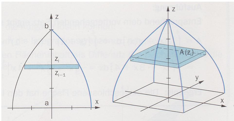
Durch eine Summe (vieler) kleiner Produkte  $A(z_i) \cdot \Delta z$  (Produktsumme) wird das Volumen des Körpers näherungsweise berechnet.
