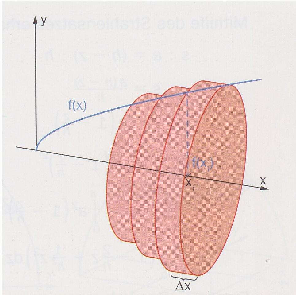
Ein Rotationskörper entsteht, wenn sich eine Kurve um  $360^\circ$  um eine Achse dreht. Diese Kurve wird *Erzeugende* genannt.
